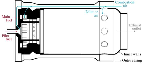
Figure 2. SECTION OF TURBEC T100 BURNER [4]
